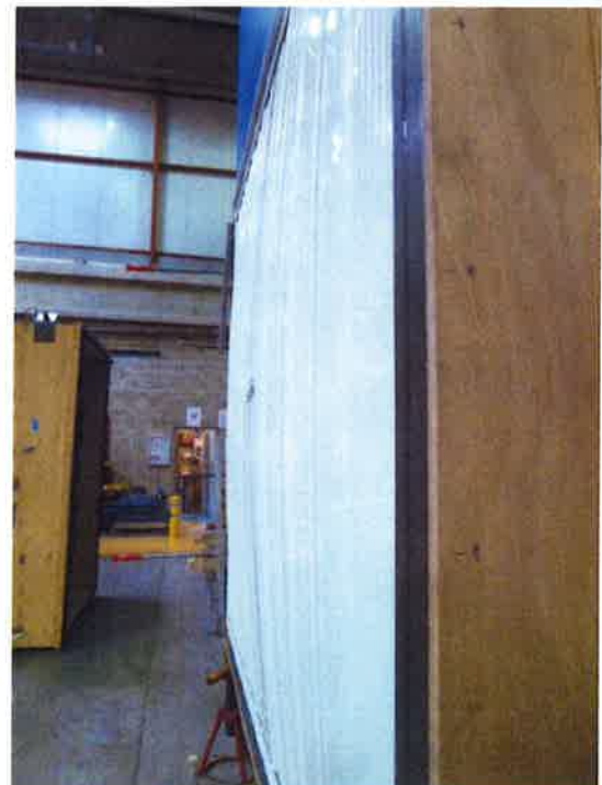
Essai en pression FS=+600 Pa
