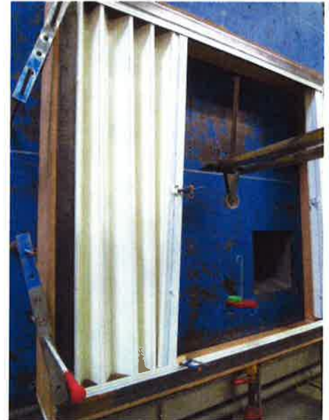
Essai fausse manœuvre sans repliement
