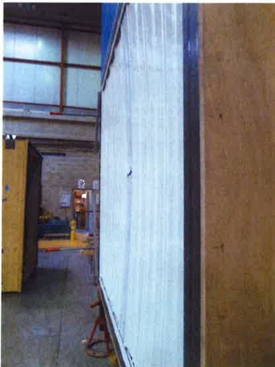
Essai en dépression FS=-600 Pa
